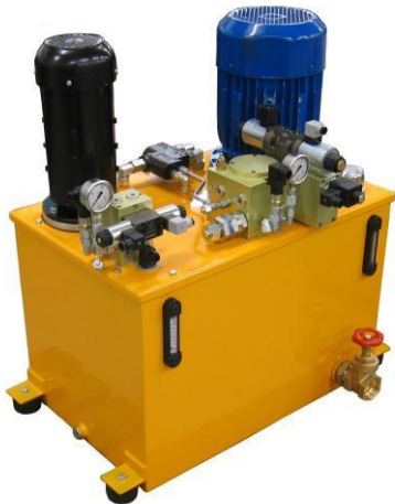
Maritiem stuursysteem met 230V electromotor en 24DC backup systeem
